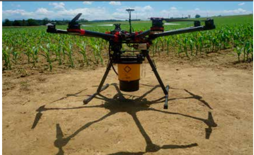
La charge utile Maïs Top concentre une grande partie de l'expertise de lâcher de trichogrammes par drone.
